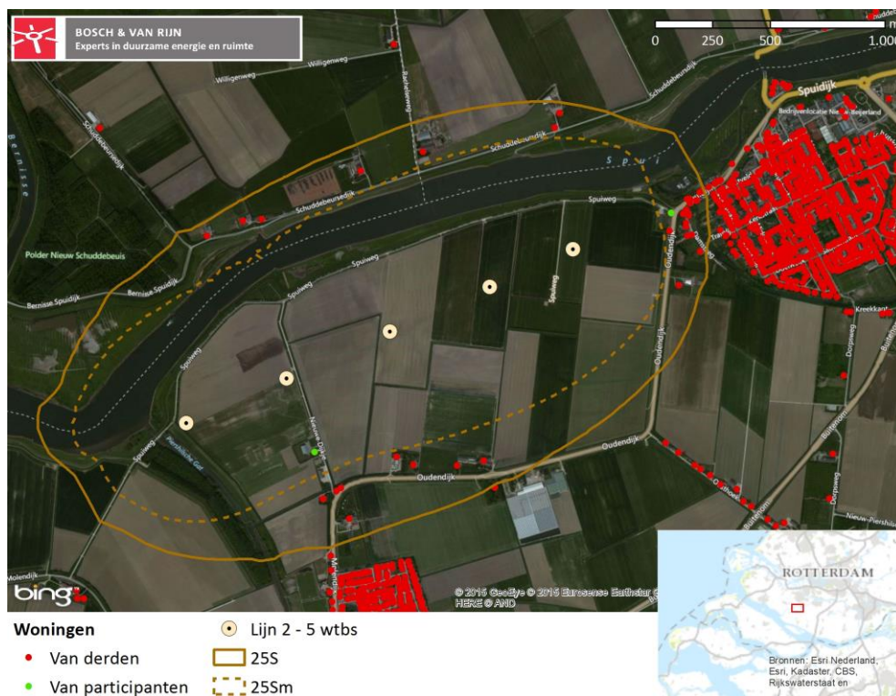
Figuur 59: 47 dB Lden contour voor en na mitigatie van opstelling R-5m.
